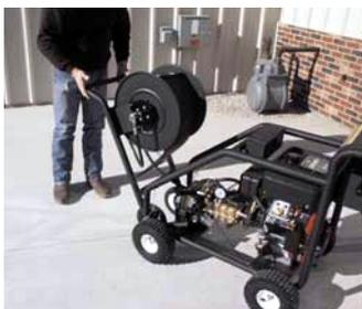
3. Потяните съемный барабан со шлангом назад, что-бы снять его с рамы.
