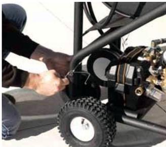
1. Установите машину на хорошо проветриваемом месте, не более 30 м от места прочистки. Обязательно используйте стояночный тормоз, который расположен между задними колесами.
